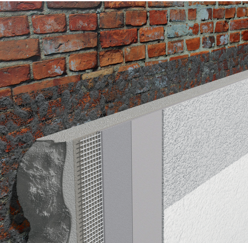
Aufbau eines klassischen Wärmedämmputzsystems.
