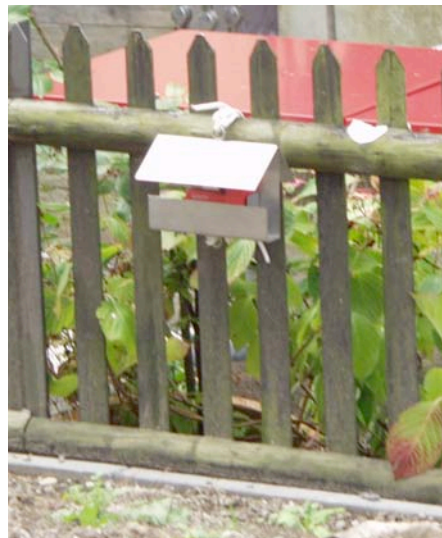
Bild 5.4: Ecolog Temperatur-Luftfeuchtigkeitsmessgerät strahlungs- und witterungsgeschützt auf der Südseite der Liegenschaft
